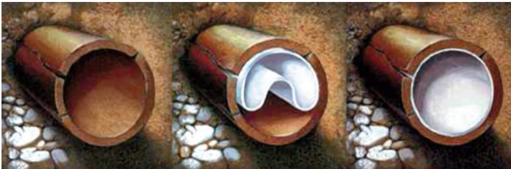
Снимки 3-37: Облицоване с предварително нагъната полиетиленова обшивка
