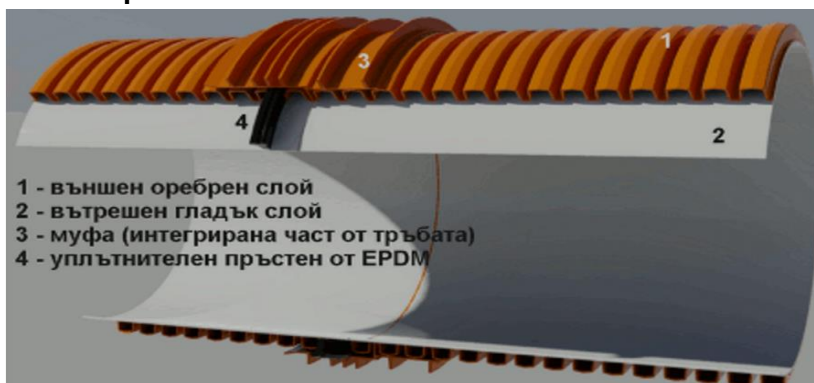
Снимки 3-5: Разрез на Двуслойни PP тръби
