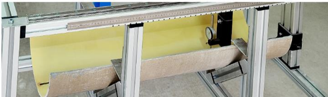
Снимки 3-20: Тест за устойчивост на абразия метода „Дармщат“
